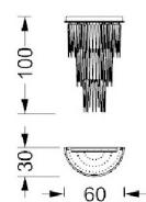
Lampadario con telaio in vetro a specchio con cornice di tamponamento copricavi. Elementi pendenti in vetro di Murano massiccio con LED interno. (1W G4 12V 2700K-3000K)
